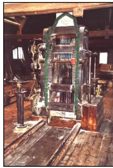
Abb. 4.12.23: Das Sägegatter aus dem Jahre 1898.
