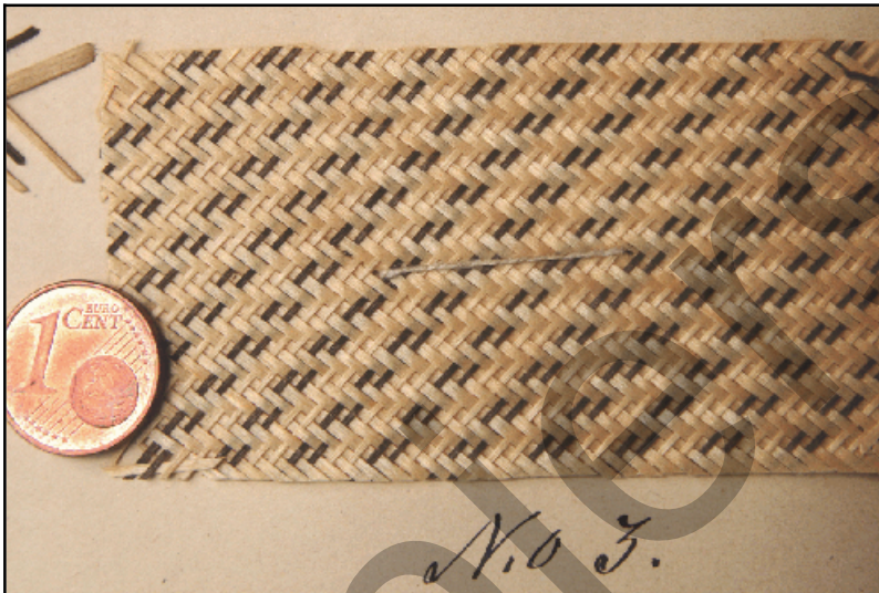
Abb. 4.11.43: Ein Muster der Holzspanweberei von 1875 aus dem Museum Gottleuba mit einem Cent zum Größenvergleich.
