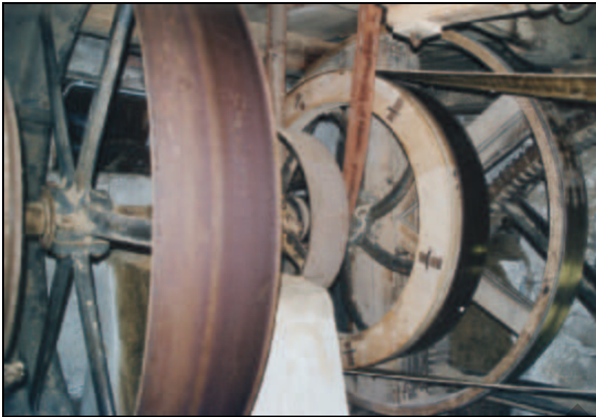
Abb. 2.99: Die Verteilerwelle der Zwiesselmühle mit dem großen Rad auf der Königswelle (rechts) im Jahre 2004.
