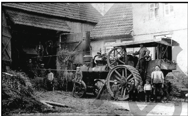
Abb. 1.10.35: Dreschen mit einer dampfgetriebenen Lokomobile als Antrieb.
