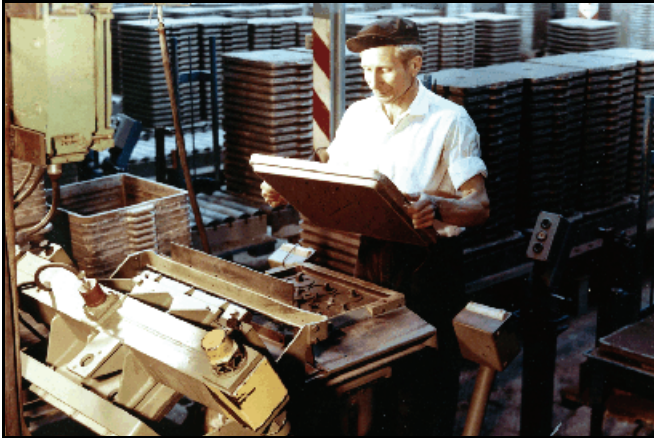
Abb. 5.13.10: Maschinenformer Helmut Zimmermann beim Formen von Kolbenringen 1974. Foto: Samml. Frau Streit, Bergg.
