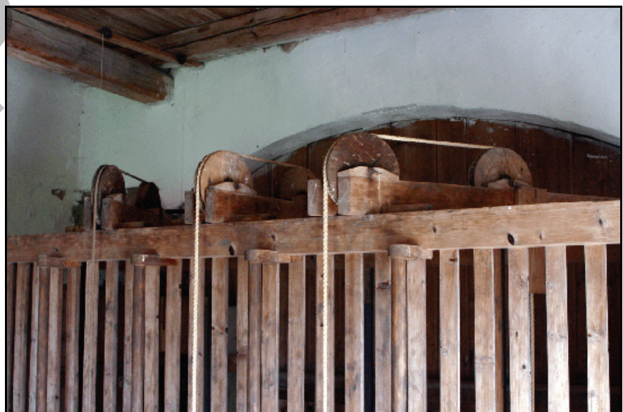
Abb. 7.1.26: Die Umlenkrollen zu den Blasebälgen 2006.
