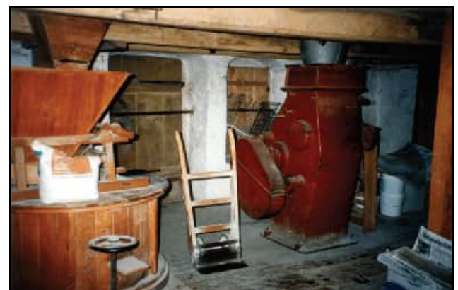
Abb. 8.2.17: Mahlgänge in der Kretschmarmühle
